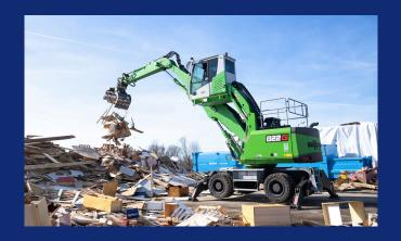
La SENNEBOGEN 822MG est une grue de manutention compacte pour les travaux de chargement et de tri dans diverses industries, disponible avec un châssis mobile sur pneus. Grâce à sa construction robuste, sa facilité d'entretien et sa simplicité d'utilisation, c'est un talent polyvalent.
