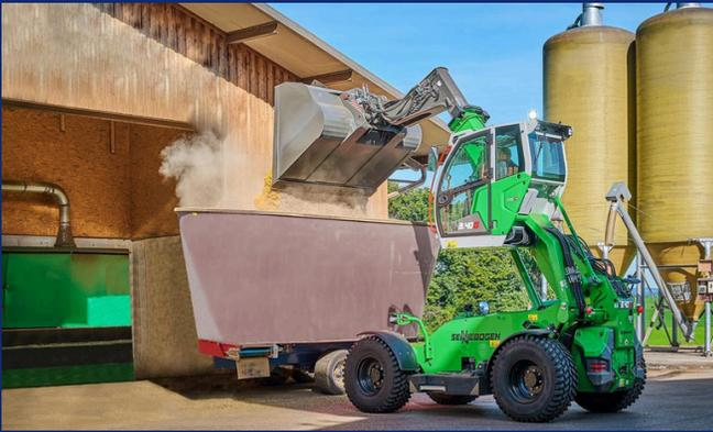
Cette machine de 4 tonnes impressionne par ses dimensions compactes de 5,50 m de longueur et un peu moins de 2,50 m de largeur. La hauteur de levage du bras télescopique est de 7,70 m. Le 340G offre une stabilité unique grâce à l'empattement long de 3,10 m et au centre de gravité bas avec un poids de 9,3 tonnes.
